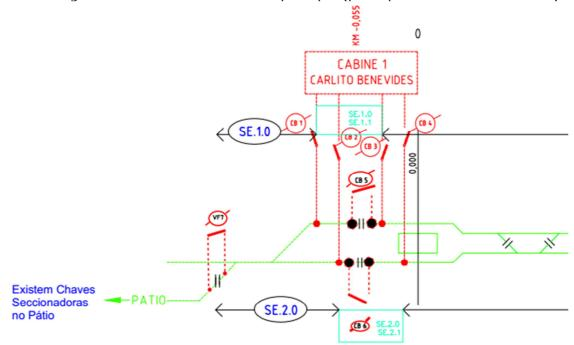
2- Diagrama unifilar simplificado 69KVA//3KVCC abaixo (parte para resolver a manobra):
