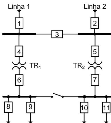
Na ocorrência de uma falha no transformador  $TR_1$ , ele desliga pela abertura dos disjuntores
