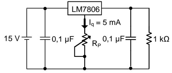
O valor do potenciômetro, em kΩ, do circuito mostrado na figura acima, de forma que a tensão sobre o resistor de 1 kΩ possa variar de 6 V a 10 V, é igual a
