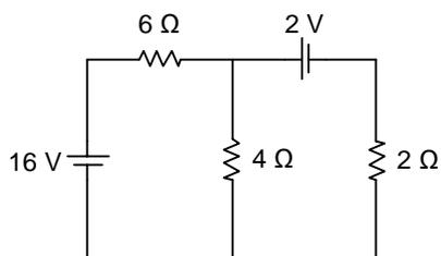
A tensão elétrica sobre o resistor de  $6\ \Omega$  do circuito mostrado na figura acima, em V, é igual a
