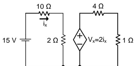
O valor da potência elétrica dissipada pelo resistor de  $4\ \Omega$  do circuito mostrado na figura acima, em W, é igual a
