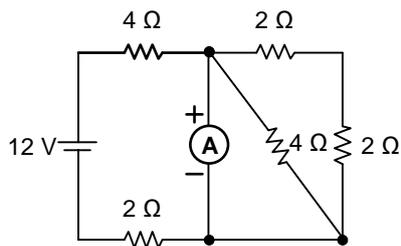
O valor da corrente elétrica medida pelo amperímetro ideal no circuito mostrado na figura acima, em A, é igual a
