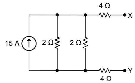
A tensão e a resistência equivalentes de Thévenin nos terminais X e Y do circuito acima representado são, respectivamente,
