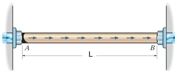
O tubo foi instalado quando a temperatura do fluido que o atravessa estava em  $25\text{ }^{\circ}\text{C}$ , e a força que as conexões A e B exerciam sobre as paredes dos reservatórios era nula. Sabendo que o fluido de trabalho varia a sua temperatura entre  $-5\text{ }^{\circ}\text{C}$  e  $180\text{ }^{\circ}\text{C}$ , a força máxima exercida sobre as paredes dos reservatórios, considerando que as mesmas são estáticas e indeformáveis, é de
