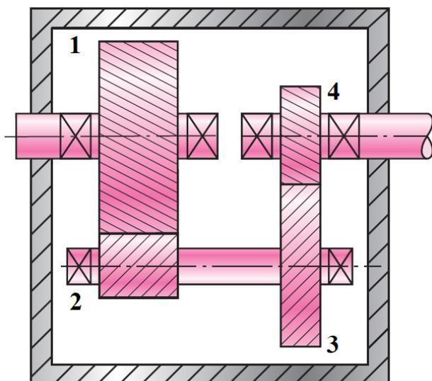
A figura acima representa um sistema de transmissão por engrenagens. Considere que um motor fornece uma potência de 15 kW a 1800 RPM no eixo junto da engrenagem 1. Desprezando-se as perdas de potência no sistema, a velocidade no eixo de saída junto à engrenagem 4 é de
