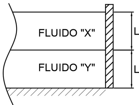
Sabendo que a comporta tem uma largura "B", que a superfície superior do fluido "X" está exposta à atmosfera, e que, no sistema, atua uma aceleração da gravidade "g", é correto dizer que a força resultante exercida por esses fluidos represados sobre a comporta é dada pela equação
