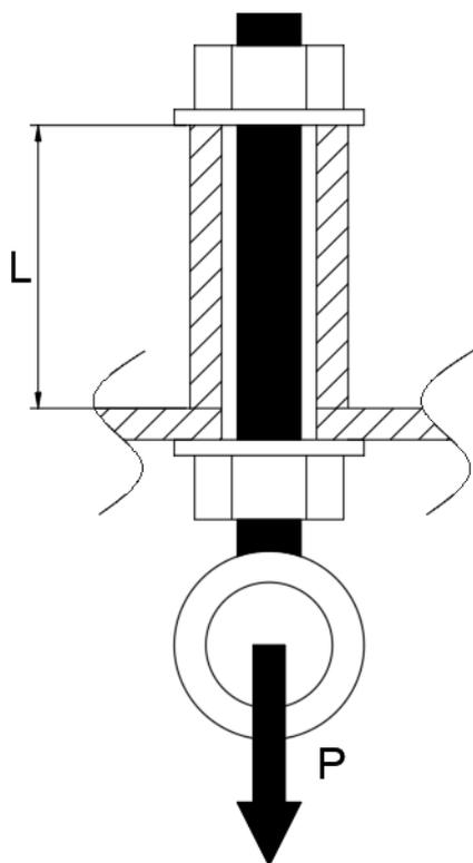
No processo de fixação do parafuso, foi aplicada uma pré-carga através do aperto das porcas equivalente a 150 kg, deixando o cilindro com um comprimento "L". Posteriormente foi aplicada uma carga "P" no olhal equivalente a 120 kg, fazendo com que a tensão atuante no parafuso na seção de comprimento "L" fosse equivalente a uma carga de
