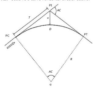
Sabendo-se que PI (ponto de interseção das tangentes) = 148 + 5.6 m; AC (ângulo central da curva) =  $25^{\circ}$ ; R (raio da curva) = 600.00 m; e tg ( $12.5^{\circ}$ ) = 0.22, e considerando  $\pi$  = 3, pode-se afirmar que o cálculo correto das estacas do PC (início da curva horizontal circular) e do PT (fim da curva horizontal circular) corresponde a
